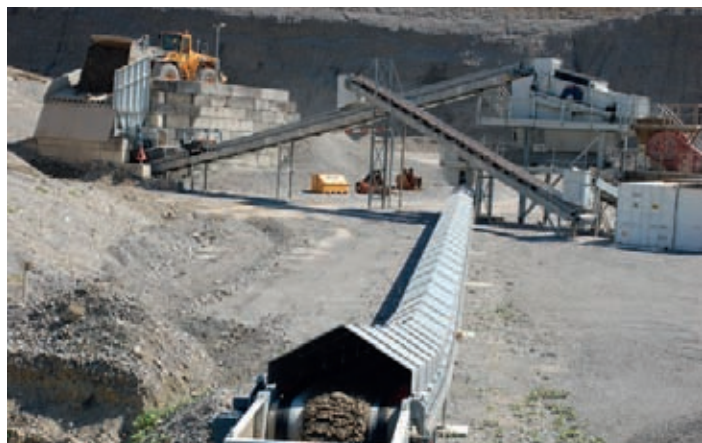
Die Beschickung der Aufgabestation mit Rohmaterial erfolgt mit dem Pneulader. Für die Zerkleinerung sind zwei der vorhandenen Brecher in das neue Materialfluss-System integriert worden
