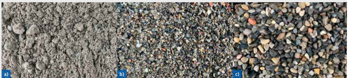
Nasschemisch aufbereitete Gesteinskörnung: a) RW-Sand 0/1, b) RW-Sand 0/4, c) RW-Kies 0/8, Wet-chemically processed aggregate: a) RW sand 0/1, b) RW sand 0/4, c) RW gravel 0/8,
