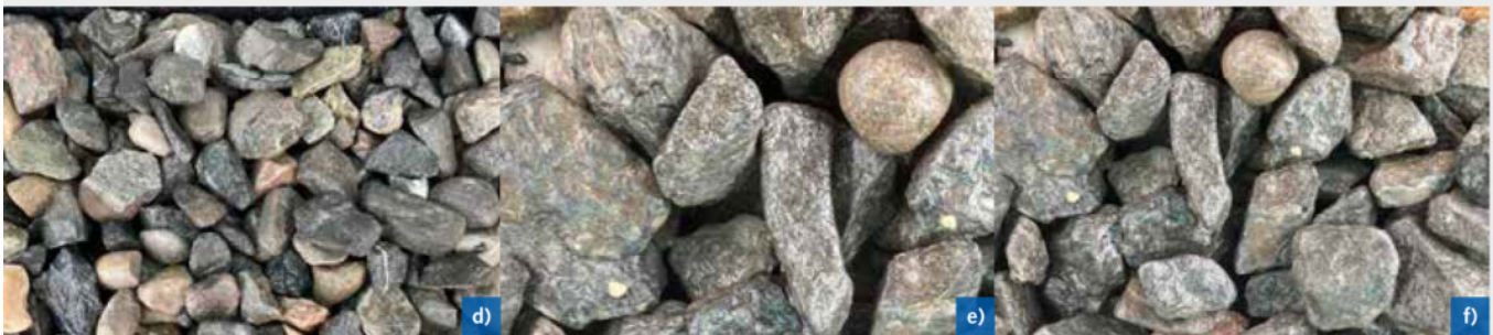
d) RW-Hartgestein 8/16, e) RW-Hartgestein 16/32, f) RW-Hartgestein 32/64 d) RW hard rock 8/16, e) RW hard rock 16/32, f) RW hard rock 32/64
